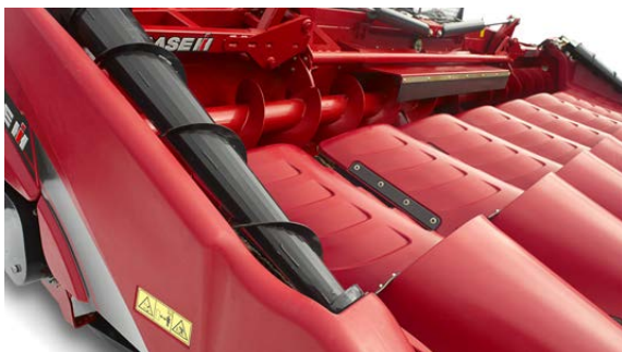
Spirálový šnekový dopravník pro polehlé porosty a žaluzie pro zadržení zrna – perfektní konstrukce pro sklizeň beze ztrát.
