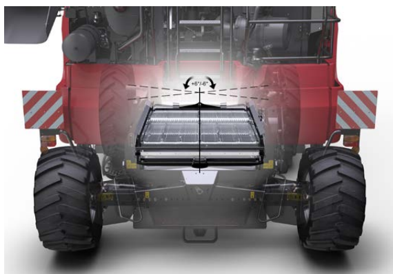
Velký povrch samovyrovnávacích sít zajišťuje vynikající čistící výkon.
