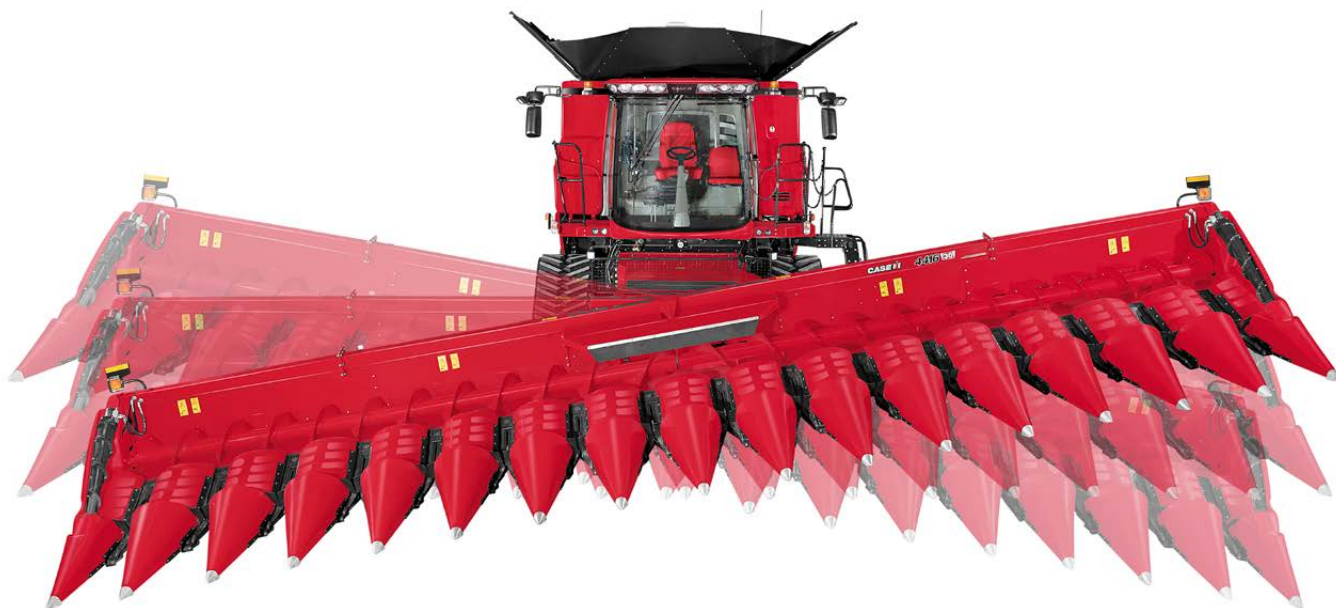
Technologie kopírování terénu Case IH Terrain Tracker zajišťuje zachování přesné výšky sečení i na nejnerovnější zemi.
