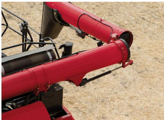
Pro sklopné verze jsou pro snadnější přepravu po silnici a pro snadnější manévrovatelnost v halách pro uskladnění k dispozici vyprazdňovací šnekové dopravníky délky 8,8 m a 12,0 m.
