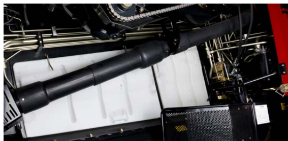
Pohon Power Plus přenáší vysoký výkon na šikmý dopravník a adaptér. Jednoduchá, nízkoúdržbová konstrukce.
