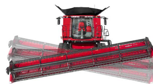
Technologie kopírování terénu Case IH Terrain Tracker zajišťuje zachování přesné výšky sečení i na nejnerovnější zemi.
