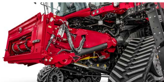
Náklon vpřed/vzad pro nastavení úhlu adaptéru – jsou sebrána všechna zrna pro minimální ztráty.
