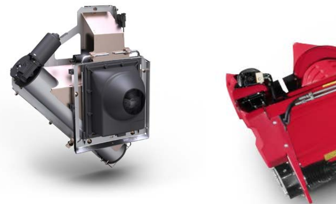
Kamera na zrno pro zjištění poškozeného zrna a v něm se nacházejících nečistot.
