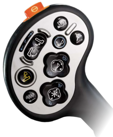
Rychlost vkládání lze ovládat stisknutím tlačítka na multifunkční páče.
