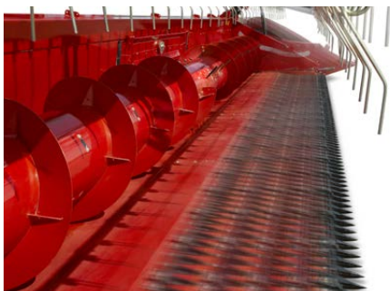
Z kabiny ovládaná, za jízdy plně hydraulicky nastavitelná poloha kosi v rozsahu až 575 mm.
