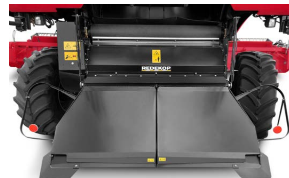
Systém Xtra-Chopping s nezávislými rozmetacími deskami.
