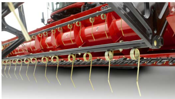
Cenný přínos: Prsty přiháněče sahají 7,5 cm pod žací kosu, aby zvedaly plodiny a snížily možnost poškození kosi.
