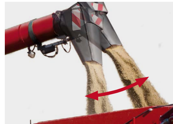
Výložník s nastavitelnou koncovkou se ovládá multifunkční pákou a usměrňuje proud zrna do vozíku na zrna, který plní na maximální hladinu bez rozsypání.
