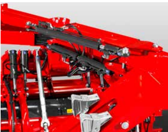
Hydraulický systém na přepravním rámu umožňuje sběrač zařízení otočit z přepravní do pracovní polohy a buď vpravo nebo vlevo od traktoru.
