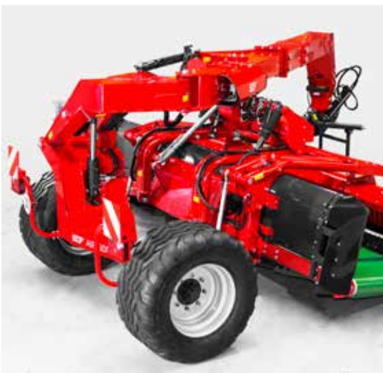
Sofistikovaný design zadního transportního rámu s koly v blízkosti sběracího zařízení.
