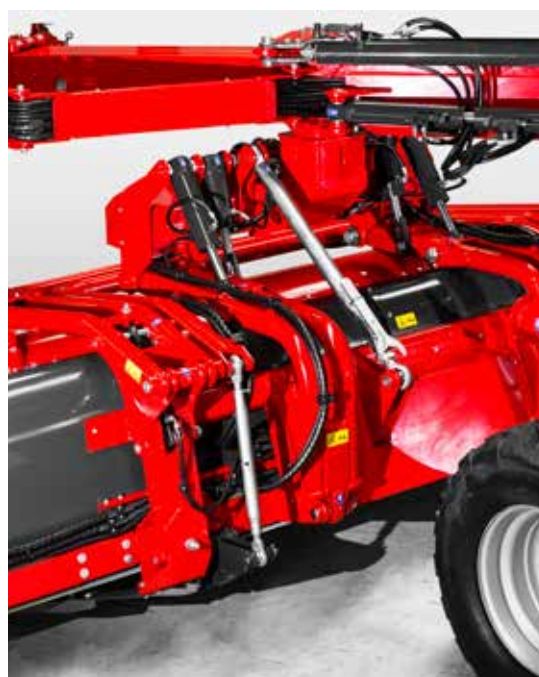
Hydropneumatické odlehčení sběrače zajišťuje vynikající kopírování terénu.
