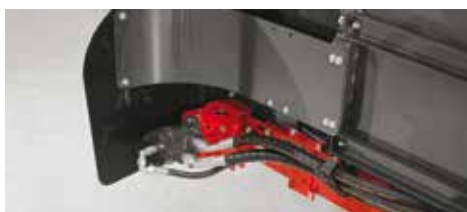
Směr a rychlost dopravního pásu lze snadno měnit díky ovládání hydromotoru.
