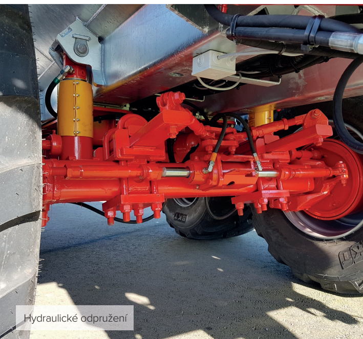
Hydraulicky odpružená oj a přední zvedací náprava
