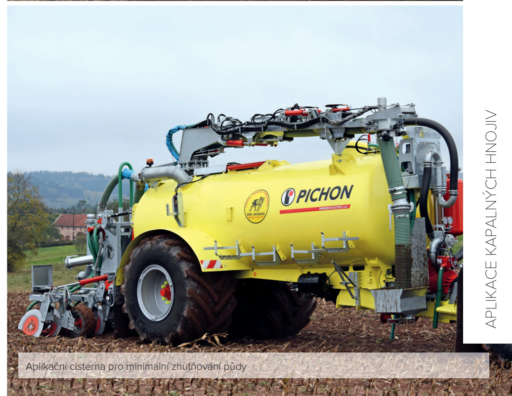
Přívozní cisterna s přepouštěcím trychtýřem
