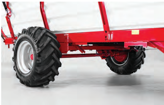
Široký rozchod a profilové pneumatiky traktoru (na přání)
