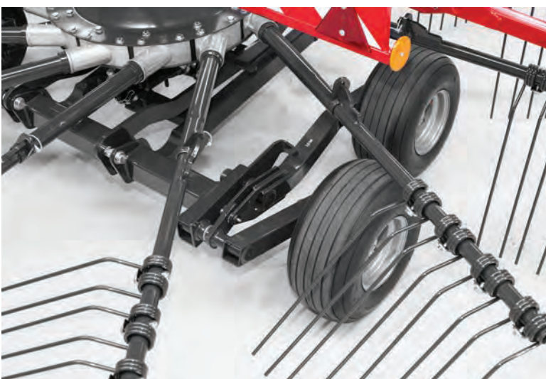
Tandemový podvozek (patent SIP) patří ke standardnímu vybavení. Umožňuje vynikající kopírování terénu, rychlejší práci a jezdovou rychlost do 40 km/h.
