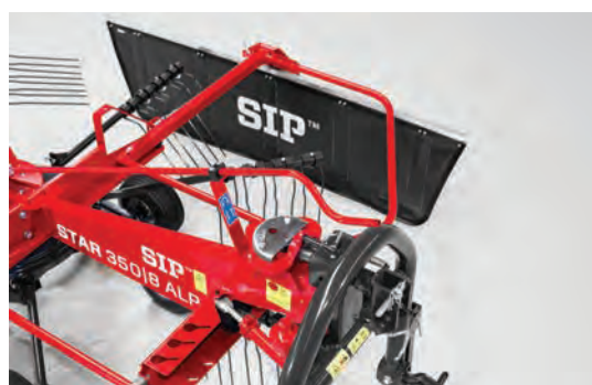
Pohodlné nastavení výšky pomocí kliky.
