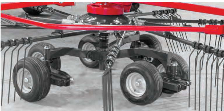
Vynikající přizpůsobení pozemku díky rozložení těžiště na tandemový podvozek. (pravý obrázek) Kola jsou umístěna tak, aby byla blízko pružinovým prstům (horní obrázek) proto poskytuje maximální stabilitu rotoru i při vysoké pracovní rychlosti.
