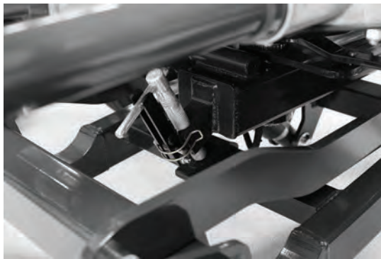
Snadné nastavení výšky rotoru pomocí závitového svorníku
