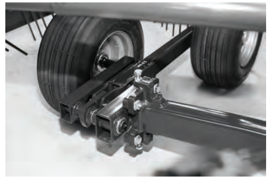
Nastavení sklonu rotoru pro čisté nabírání píce.
