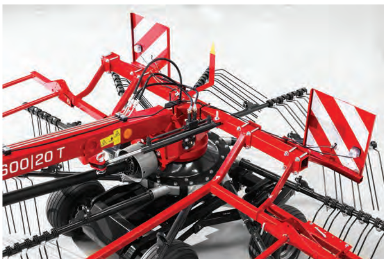
Ideální kopírování terénu díky otočnému zavěšení 3D zadního rotoru. Díky hydraulickému ovládání zadního rotoru se zkrátí pracovní doba a zvýší produktivita práce.
