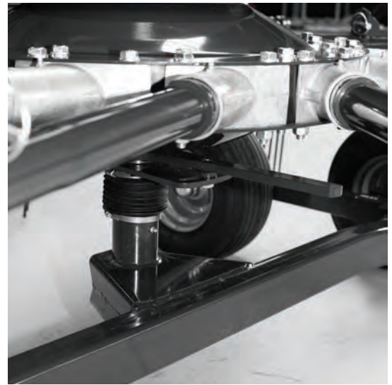
Nastavitelná vodící dráha \pm 15^\circ - v závislosti na množství a vlhkosti píce.
