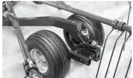
Flexibilní tandemová náprava na rotoru garantuje vynikající kopírování terénu a vyšší jezdovou rychlost. Široký podvozek se 4 nebo 6 koly umístěný blízko u pružinových prstů umožňuje vytvářet rovnoměrný a čistý řádek v celém pracovním záběru.
