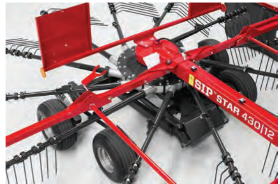
Pomocí hydrauliky lze rotor zvednout o 500 mm, aby se tak připravil do přepravní polohy.
