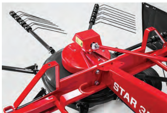
Pracovní výšku lze velmi snadno nastavovat přímo z kabiny traktoru.
