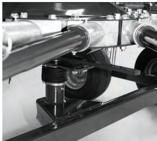
Nastavitelná vodící dráha \pm 15^\circ - v závislosti na množství a vlhkosti píce.
