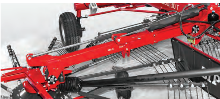
Plynulé hydraulické nastavení šířky řádku i během práce
