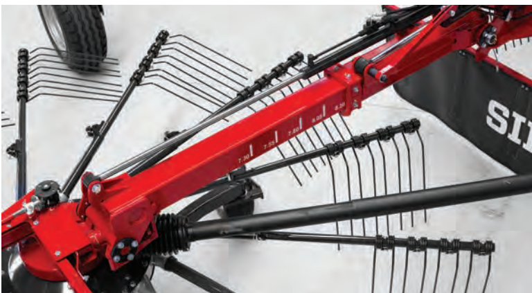
Plynulé, hydraulické nastavení šířky řádku i během práce (STAR 850I26 T)
