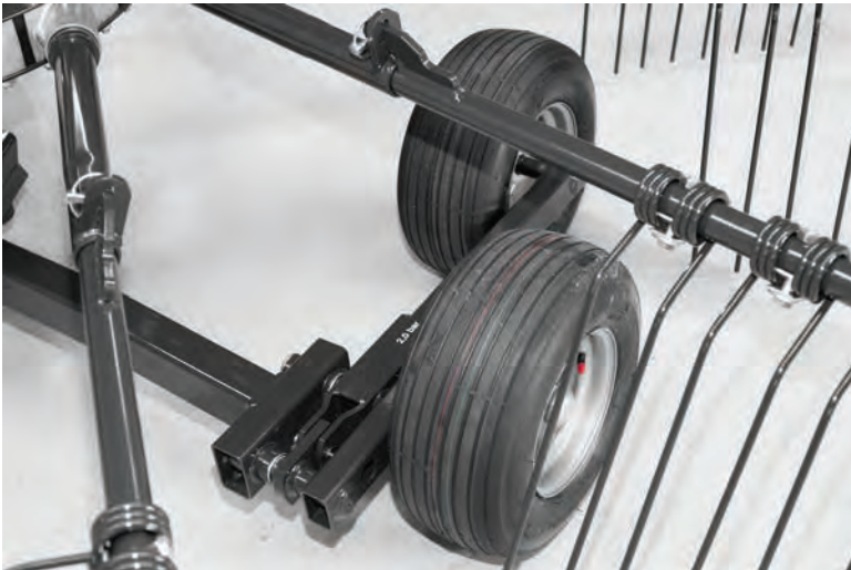
Tandemový podvozek pro optimální kopírování terénu.
