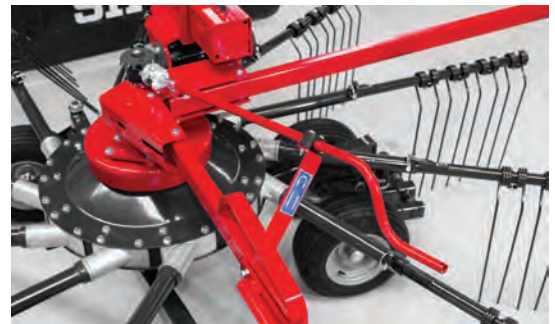
Snadné nastavení výšky rotorů.
