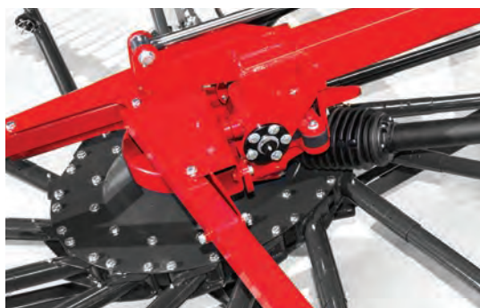
Robustní flexibilní kloub 3D před rotorovým shrnovačem.
