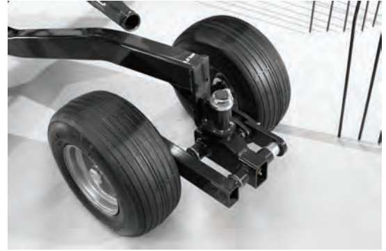
Flexibilní tandemová náprava na rotoru garantuje vynikající kopírování terénu a vyšší pojezdovou rychlost. Široký podvozek se 4 nebo 6 koly umístěný blízko u pružinových prstů umožňuje vytvářet rovnoměrný a čistý řádek v celém pracovním záběru.
