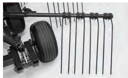
Jednotlivě vyměnitelná ramena s prsty, uložení ve dvou kuličkových ložiscích.
