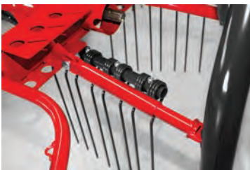
Výškové nastavení stabilizátorů na kyvném čepu
