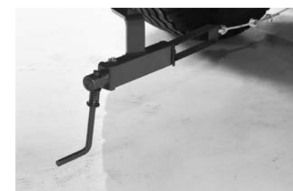
Ovládání parkovací brzdy pomocí brzdové páky.
