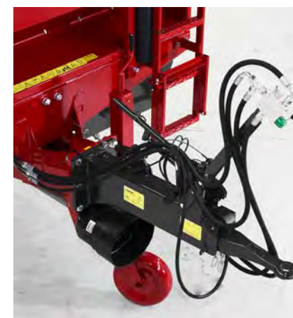
Nájezdová brzda s couvací automatikou garantuje bezpečnější jízdu s naloženým rozmetadlem.
