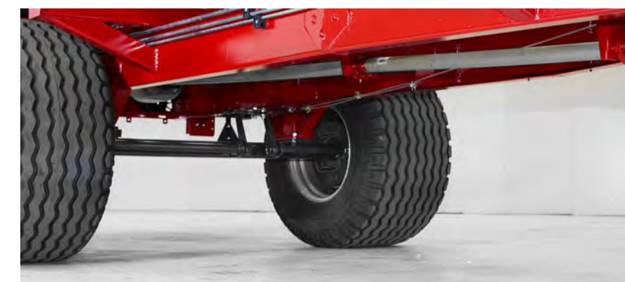
Podvozek tvaru V pro lepší stabilitu.
