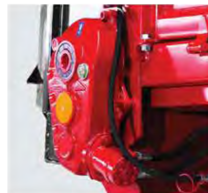
Pohon skrabákového dna zajišťuje hydraulika. Plynule nastavitelný posuv garantuje rovnoměrné posouvání materiálu.
