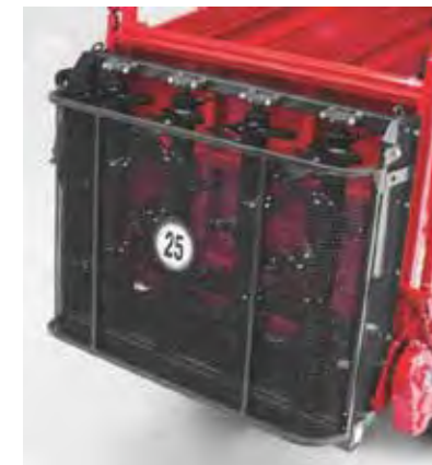
Robustní rozmetací válce z mimořádně otěruodolného materiálu, pro vysokou přesnost rozhozu a dlouhou životnost. Rozmetací ústrojí je instalované se sklonem 10°. Rozmetací ústrojí instalované pod určitým sklonem umožňuje dosažení lepšího rozmetacího obrazce.
