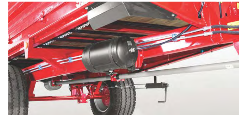
Při práci v náročném terénu se bezvadně osvědčil podvozek tvaru V, který zvyšuje stabilitu a tuhost stroje.
