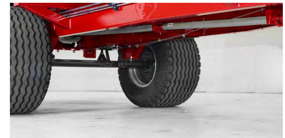
Podvozek tvaru V pro lepší stabilitu
