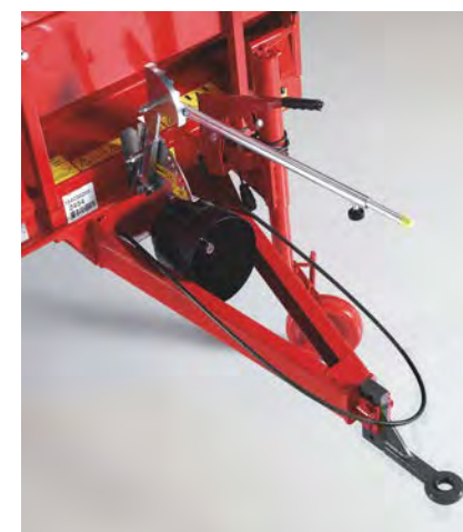
Fixní tažná oj s výškově stavitelným vlečným okem.
