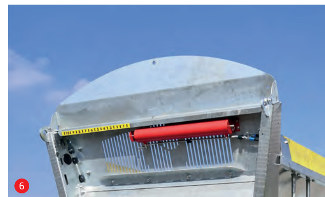
5 | Mechanický indikátor otevření gilotinových dveří
